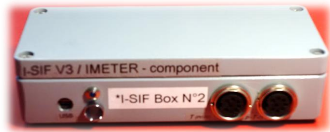
Abb. 23: I-SIF V3, Typ 2.1. von links: USB-Mini-Anschluß, LED-Signalleuchten, T -Sensor-, p, Ta, rH -Sensor-Anschluß (8 polige DIN) .
